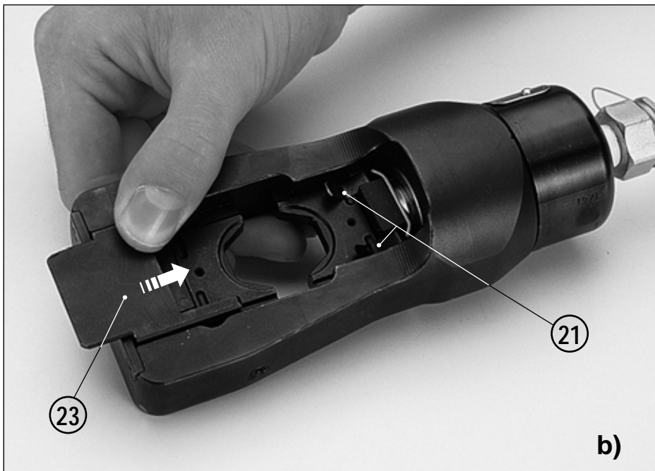
FIG. 2 DIE INSERTION - INSERTION DES MATRICES - EINRASTEN PRESSEINSÄTZE INSERCIÓN DE LAS MATRICES - INSERIMENTO MATRICI
