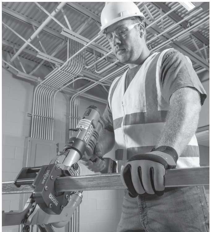
Figura 8 – Uso del cabezal de corte por cizalla
